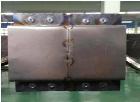
图 5：气体保护焊塞焊
