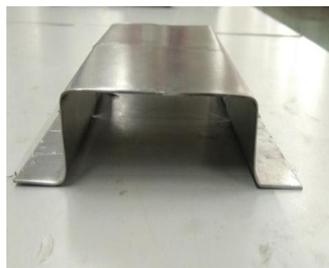
图 2：用  $160 \times 120 \times 0.8\text{mm}$  施工板料制作
