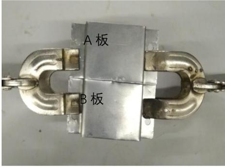
图 3：将打好孔的钣金件与衬板固定
